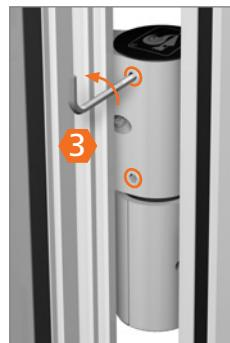
Gewindestifte mit einer  $\frac{1}{2}$ -Umdrehung lösen.
