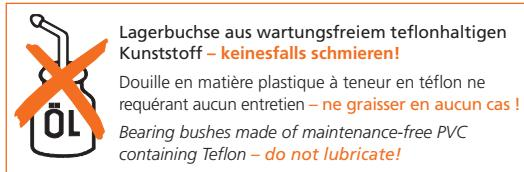
Lagerbuchse aus wartungsfreiem teflonhaltigen Kunststoff – **keinesfalls schmieren!**
