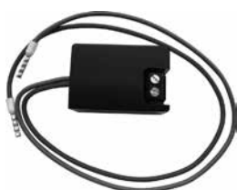
Vorlastelektronik 760-12 Verbessert die Vorlasteigenschaft bei Gleichstrombetrieb auf min. 300N. Ein kurzes Brummgeräusch am Türöffner wird ca. 0,5 Sekunden lang hörbar. Dauerstromfest, Haltestrom wird reduziert. Kompatibel zu gängigen effeff-Türöffnern.
