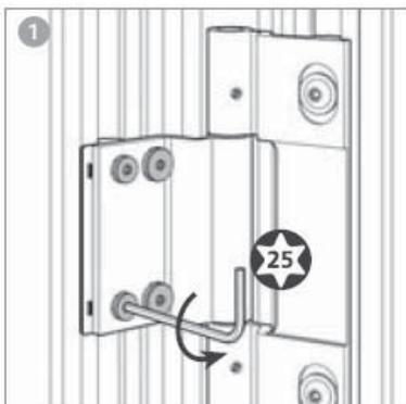
Alle Befestigungsschrauben des Flügelbandteils bis Unterkante Schraubenkopf freistellen.
