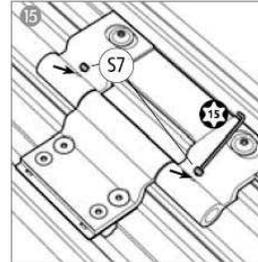
Bolzen mit den beiden Gewindestiften fixieren (2 - 8 Nm).
