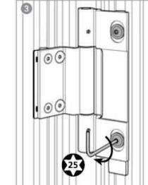
Befestigungsschrauben aller Rahmenbandteile anziehen (10 - 14 Nm).
