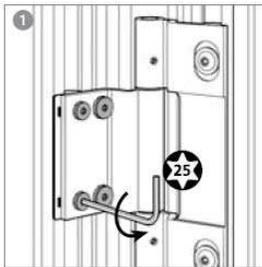
Alle Befestigungsschrauben des Flügelbandteils bis Unterseite Schraubenkopf freistellen.
