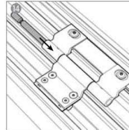
Rahmenband- und Flügelbandteil zusammenfügen, Bolzen einschieben.
