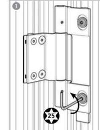
Alle Befestigungsschrauben der Rahmenbandteile aller Bänder 1 - 2 Umdrehungen lösen.
