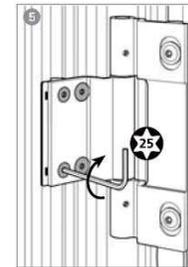
Befestigungsschrauben an allen Flügelbandteilen festziehen (10 - 14 Nm).
