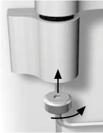
» Hebespindel montieren.
