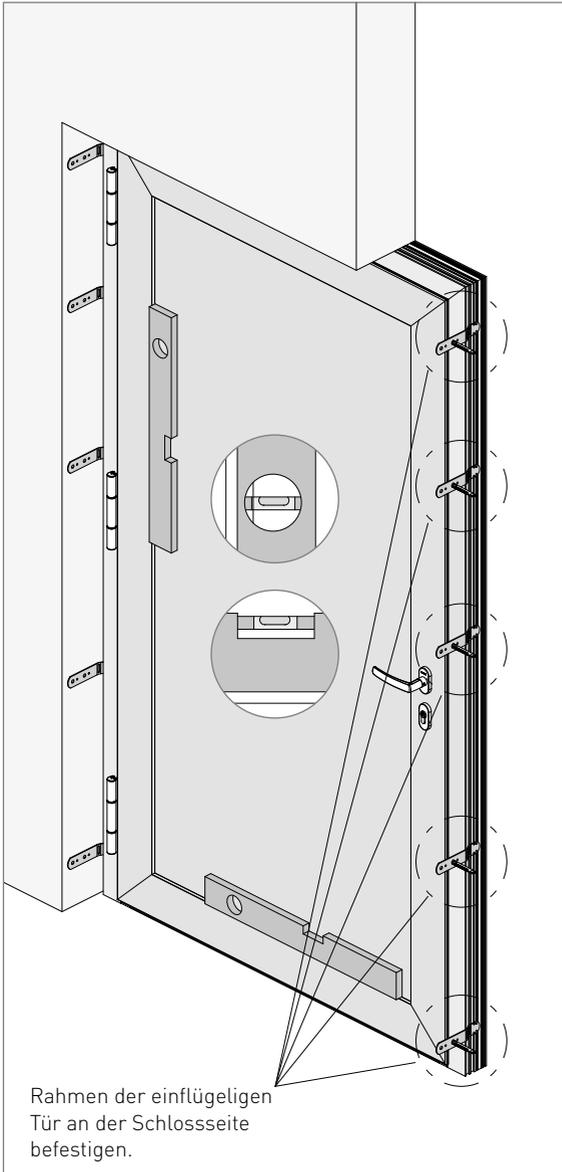
**Türflügel einhängen und ausrichten:**
