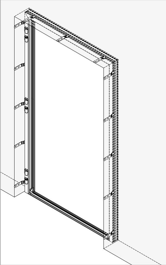
Rahmen nur an der Bandseite fest-schrauben. Bei zweiflügeligen Türen beide Bandseiten und Rahmen oben befestigen.
