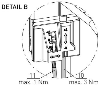
**i** » Zur Entlastung des Rollenbands den Türflügel vor der Bänderstellung mit einem Keil unterstützen.
