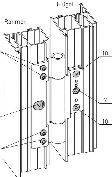
» Zur Entlastung des Rollenbands den Türflügel vor der Bänderstellung mit einem Keil unterstützen.
