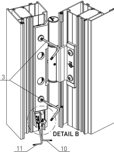
**i** » Zur Entlastung des Rollenbands den Türflügel vor der Bandeinstellung mit einem Keil unterstützen.
