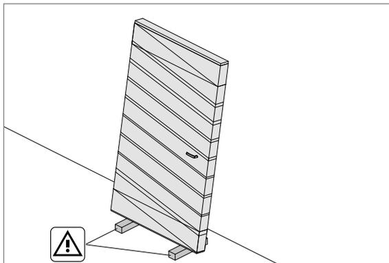
Um Beschädigungen am Türelement zu vermeiden, sollte dies auf Kant-hölzern oder ähnliches abgestellt werden. Sofern vorhanden, Transportsicherung entfernen.
