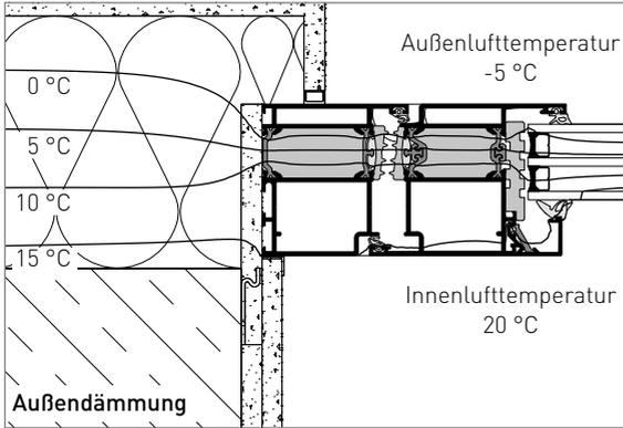
Legen Sie die Türposition in Abhängigkeit der örtlichen Befestigungsmöglichkeiten, der Wandart und der erforderlichen Rand- und Achsabstände für die Befestigungsmittel fest.
