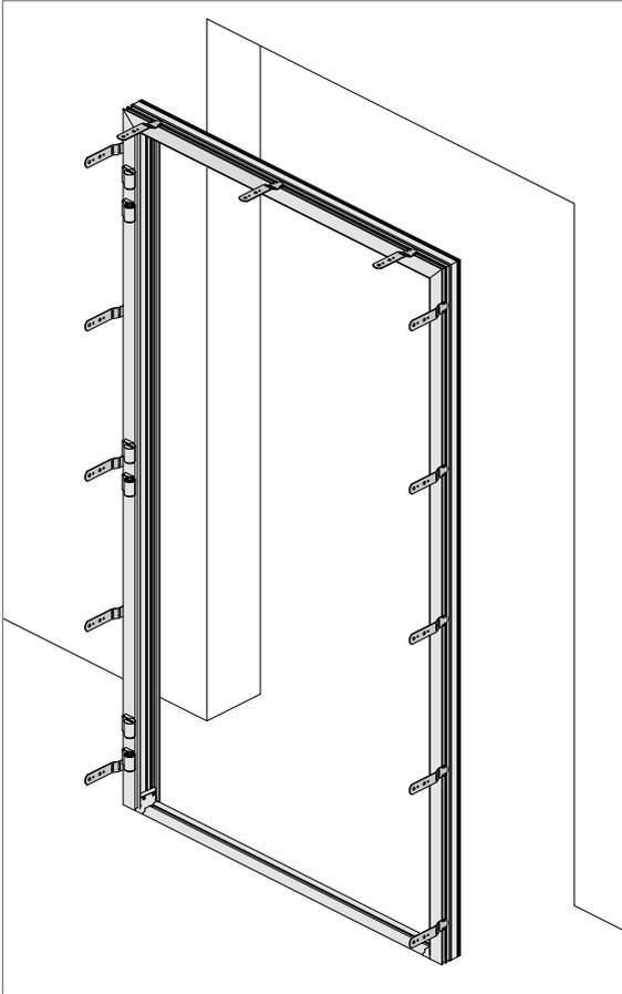
Türblatt aushängen und Eindrehanker in Aufnahmenut vom Rahmenprofil im Uhrzeigersinn eindrehen.
