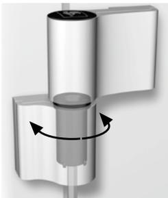
» Lagerbuchse um  $\pm 90^\circ$  drehen bis sie spürbar einrastet (Dichtungsan-druck  $\pm 0,5$  mm).
