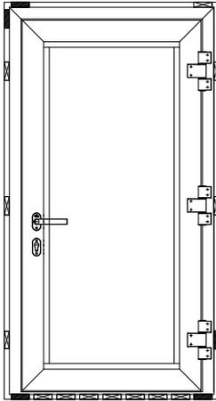
Schwelenprofil auf ganzer Breite druckfest unterfüttern / unterbauen. Tragklötze an den dargestellten Positionen einbringen und dauerhaft gegen verrutschen sichern.
